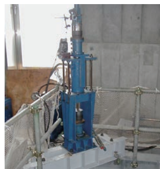
内筒管リフトアップ (ストランドチャッキングシステム)
